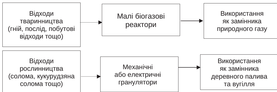
Рис. 1. Принципова схема переробки відходів сільськогосподарської діяльності в особистих селянських господарствах на біогаз та тверде біопаливо
